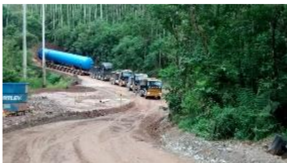
Figuras 17 : Transporte dos RHO's com Linha de Eixo e 04 (quatro) Cavalos Pedra para subida da Variante Doritos
